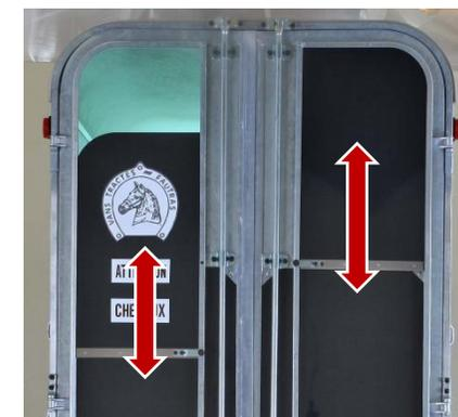
Volets coulissants intégrés dans les portes réglables en 3 positions d'aération.
