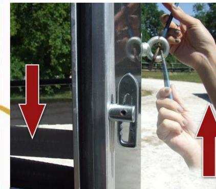
Barre de poitrail avec boucle de sécurité extérieure.
